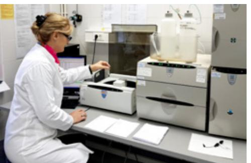
Ing. Jasna Nemčić-Jurec obavlja ispitivanja aniona i kationa na ionskom kromatografu
