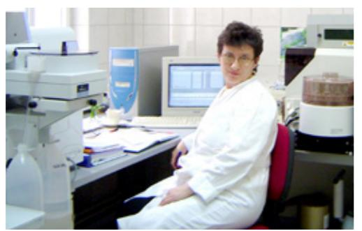
Ing. Vesna Gaži-Tomić obavlja ispitivanja teških metala na atomskom spektrofotometru
